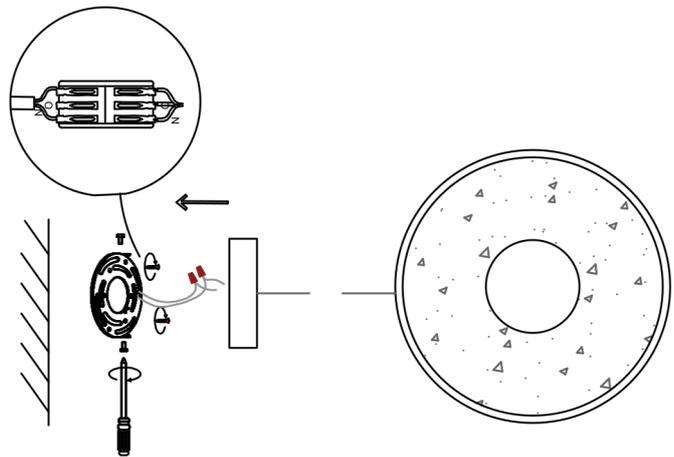
Installer le corps de la lampe sur la plaque de suspension
