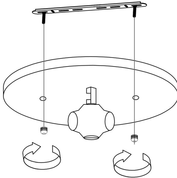
Utilisez des écrous fabriqués à la main pour fixer le corps de la lampe sur la planche suspendue
