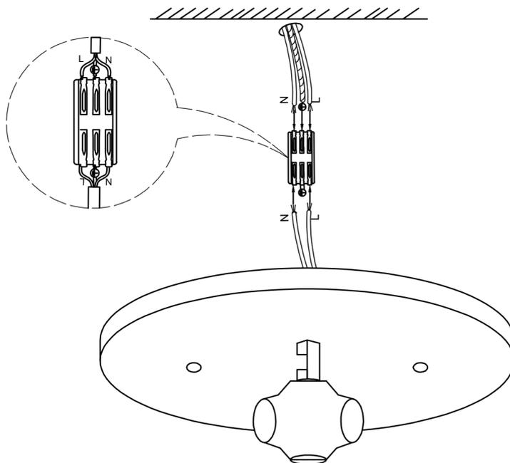
Les fils de la maison sont connectés aux fils des lampes via les bornes de fils
