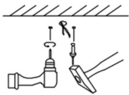
Percez des trous dans le plafond et insérez des vis d'expansion
