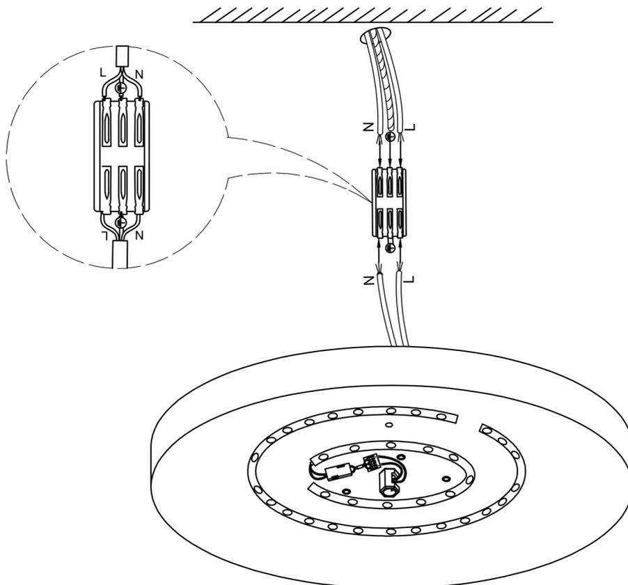
Les fils de la maison sont connectés aux fils des lampes via les bornes de fils
