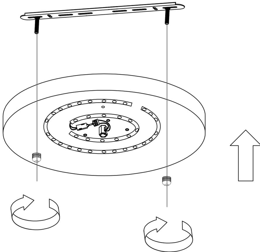
Utilisez des écrous fabriqués à la main pour fixer le corps de la lampe sur la planche suspendue
