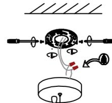
Installer le corps de la lampe sur la plaque de suspension
