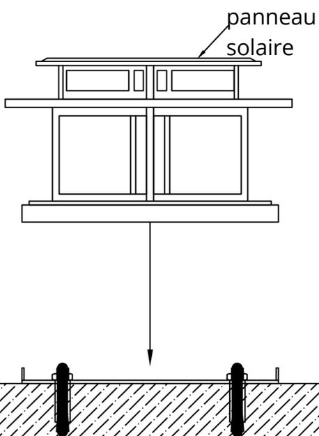
4. Serrez les vis sur le côté pour fixer la base et le corps de la lampe
