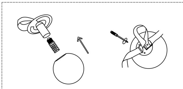
La tôle de fer crantée est insérée dans l'abat-jour et fixée avec des vis
