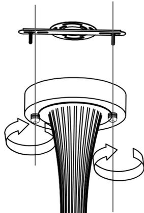
Utilisez des écrous fabriqués à la main pour fixer le corps de la lampe sur la planche suspendue
