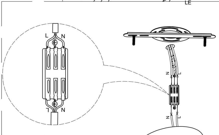
Les fils de la maison sont connectés aux fils des lampes via les bornes de fils
