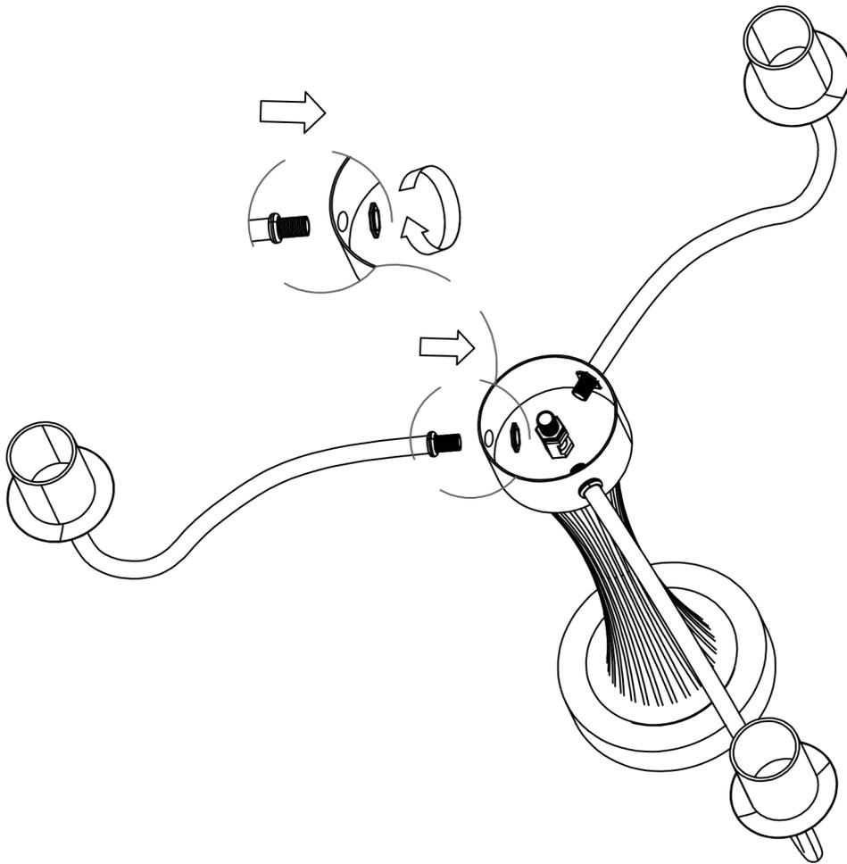
Utilisez des vis pour verrouiller le bras de la lampe sur le corps de la lampe
