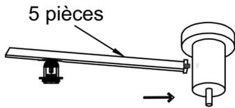
Montage du corps de la lampe : le bras de la lampe est relié au poteau central par des vis
