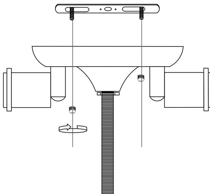
Utilisez des écrous fabriqués à la main pour verrouiller le corps de la lampe sur la plaque de suspension
