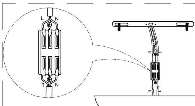
Les fils de la maison sont connectés aux fils des lampes via les bornes de fils
