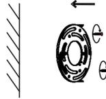
Installez la plaque de suspension sur le mur
