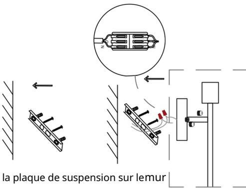
Installez la plaque de suspension sur le mur
