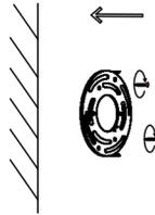
Installer la plaque de suspension sur le mur
