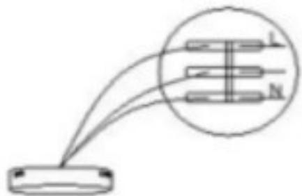
2. Connectez l'alimentation électrique domestique de AC110V-AC240V.
