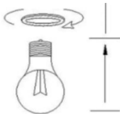
**Remarque : 1. Tension : AC110 V-AC240 V Puissance maximale : 60 W 2. Assurez-vous que l'alimentation est coupée avant l'installation.**
