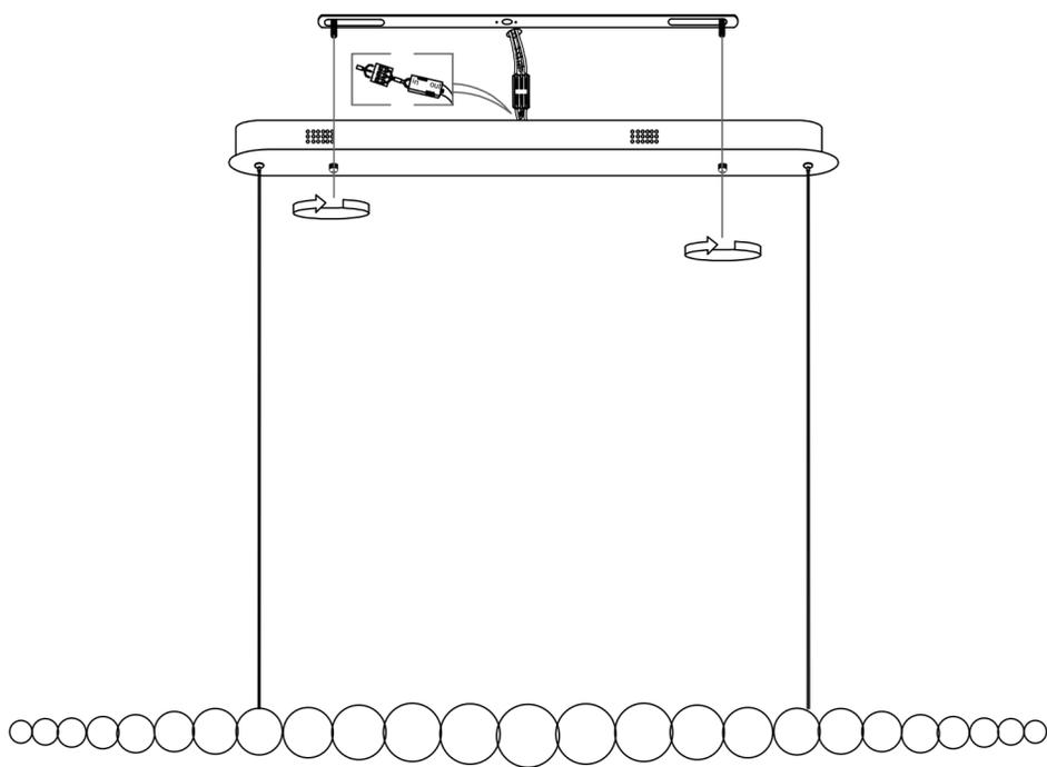
Utilisez des écrous fabriqués à la main pour fixer le corps de la lampe sur la planche suspendue
