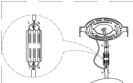
Les fils de la maison sont connectés aux fils des lampes via les bornes de fils
