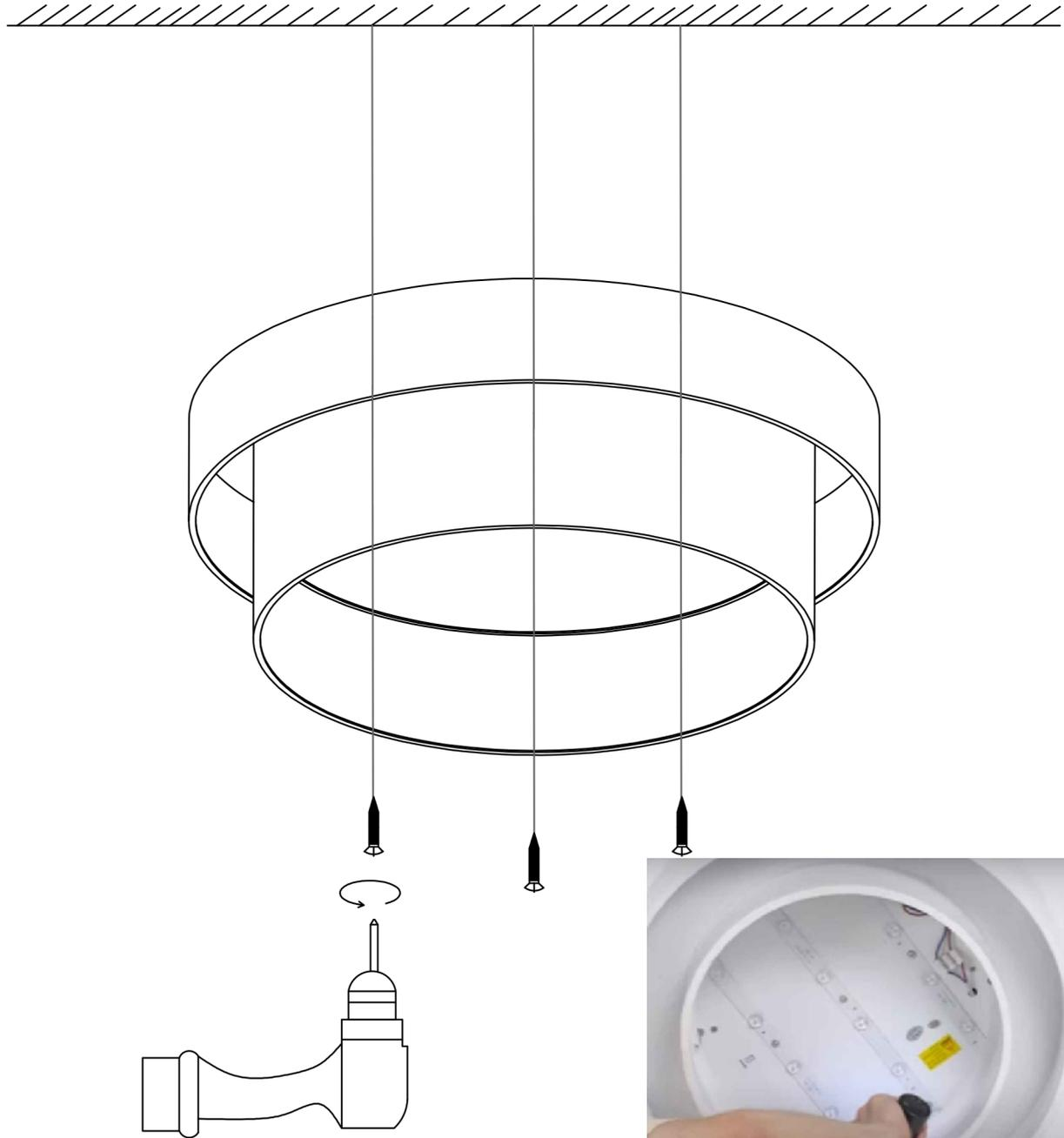
Une fois les fils connectés, utilisez des vis pour fixer le corps de la lampe au plafond.
