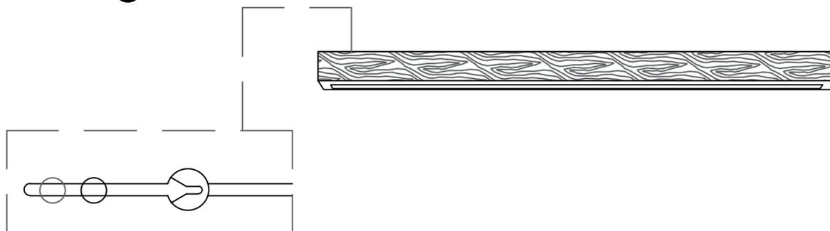
L'encoche à l'arrière de la lampe s'accroche au bouchon à vis sur le mur
