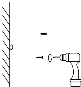
Fixez les vis sur le mur et faites couler les bouchons à vis
